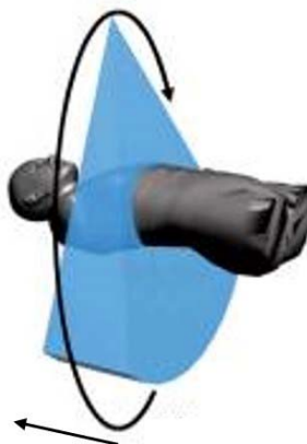
Рис. 4.8. Принцип работы компьютерного томографа [по Dance D.R. с колл., 2014 с изм.]
